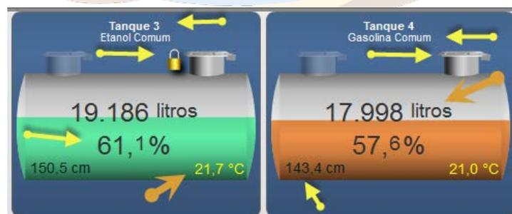
Para obtenção de informações detalhadas de um compartimento de tanque específico, basta clicar sobre o compartimento escolhido para que o sistema apresente as informações detalhadas em tela cheia, incluindo volume convertido a 20°C (temperatura adotada internacionalmente como padrão para medição de volumes de combustíveis).
